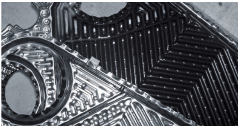
Zentrum des Temperaturwechsels: Je sauberer die Lamellen, Hohl- und Zwischenräume, desto besser kann das Leitmedium des Wärmetauschers zirkulieren.
