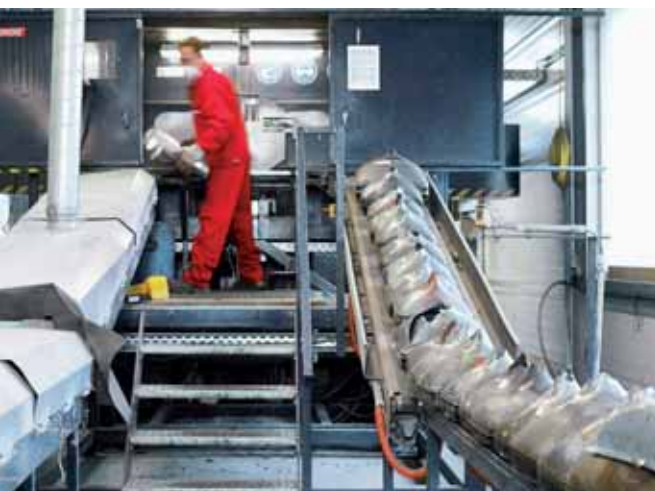
W naszym centrum elektrorecyklingu, po wstępnym, częściowym demontażu ręcznym, następuje dokładny rozdział na czyste frakcje.
